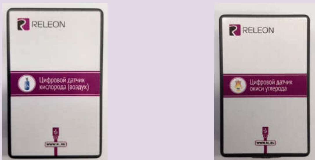
Рис. 11. Датчики кислорода (слева) и угарного газа (справа)
