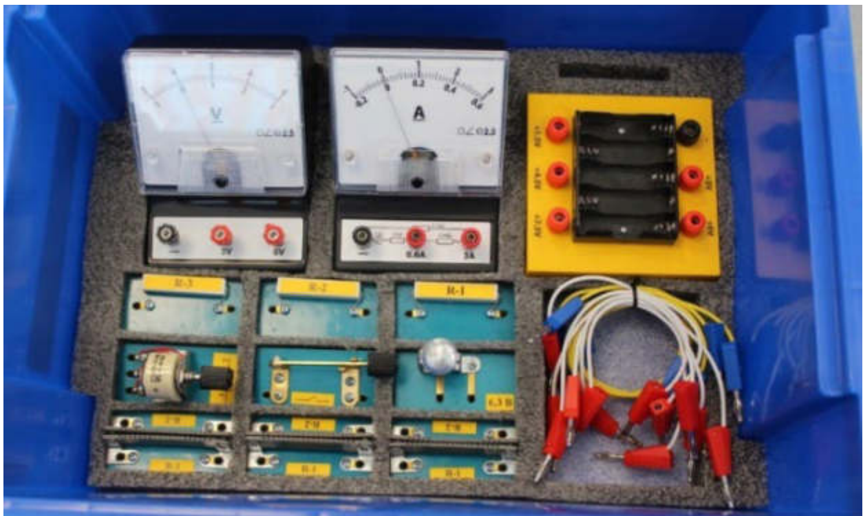
Рис. 2. Оборудование комплекта для проведения экспериментов по электродинамике
